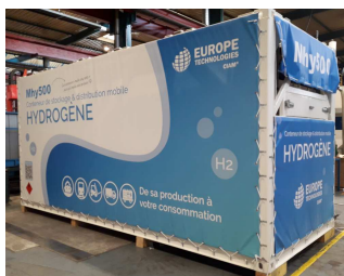
Chargement de l'H2 par swapping de containers (450 kg/container)
